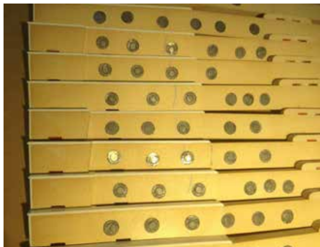
Foto 16 - Detail oorspronkelijk loodpatroon witte toetsen
