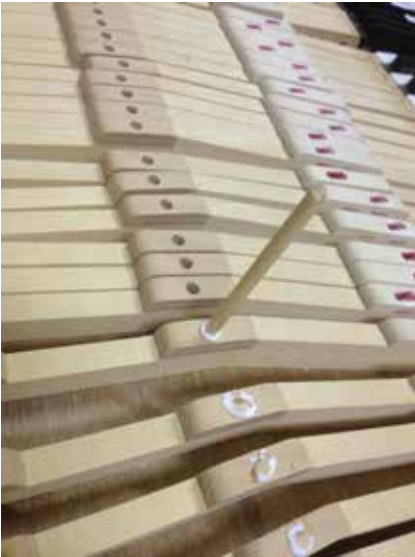
Foto 9 - Oude pilotengaten opvullen
