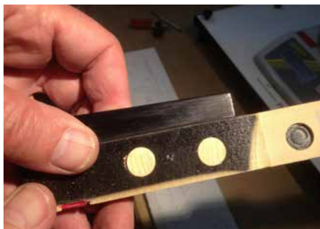
Foto 18 - Oud lood uit toets verwijderd en gaten gevuld.
