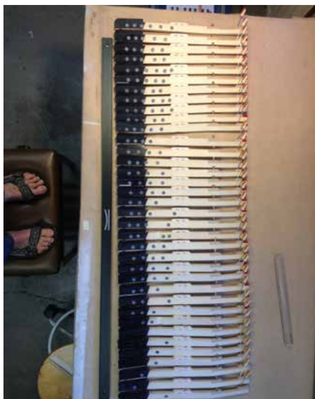
Foto 17 - Oorspronkelijk loodpatroon zwarte toetsen (zomer)
